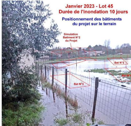
Or l'étude hydrogéologique qu'a fait réaliser le demandeur du permis de construire conclut, à partir de sondages réalisés en juin, que le niveau haut de la nappe est susceptible de se trouver entre 30 et 50 cm sous le terrain naturel.
